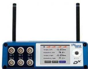
L'unità ricevente D<sup>x</sup> RCI viene utilizzata per la parametrizzazione e l'acquisizione sincrona dei segnali provenienti da un massimo di quattro trasduttori di coppia WTT installati sulle ruote di un veicolo.
